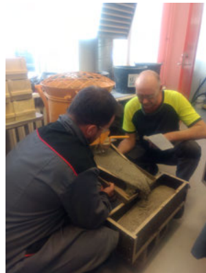
Abbildung 2: Gießen eines Zement-Probekörpers
