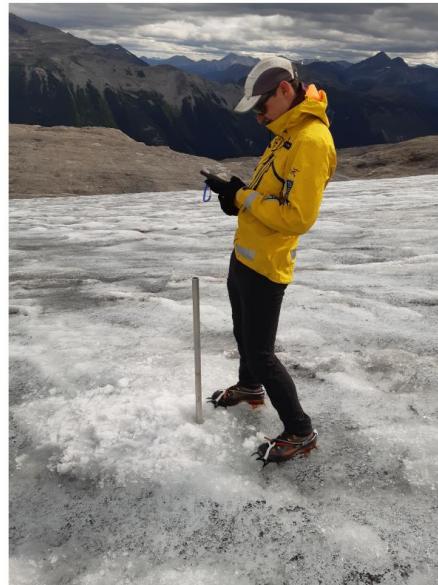
Abbildung 10: Adam notiert Werte neben einem fertigen Messstab, der initial etwa einen halben Meter aus dem Eis ragt.
