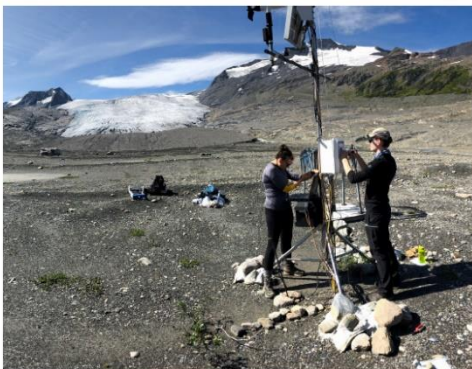
Abbildung 7: Hillary und Maurice kalibrieren eine meteorologische Messstation
