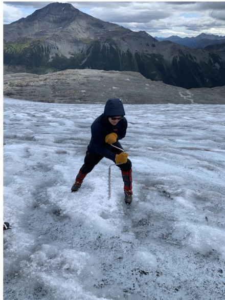
Abbildung 9: Maurice beim Bohren eines Messpunktes für die Berechnung der jährlichen Massendifferenz
