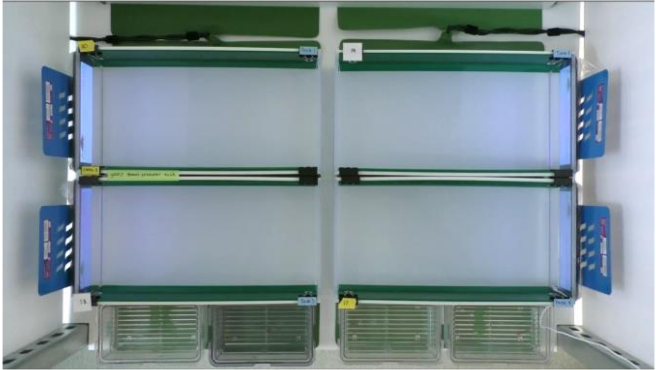
Abb. 4: Experimenteller Aufbau der Versuchsbecken. An den äußeren Beckenenden befinden sich jeweils die Tablets, welche den Fischen verschiedene Situationen vorspielen. An den innengelegenen Enden befinden sich die Blanks.
