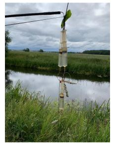
und zogen in diesem Zeitraum kontinuierlich Wasser an, sodass am Ende einer Woche ca. 90 mL Probe in der Spritze (siehe Bild) vorzufinden war. Die Substanzen, die sich in der SPE-Kartusche angesetzt hatten, wurden im Anschluss dann im Labor eluiert und schließlich mithilfe von HPLC analysiert.
