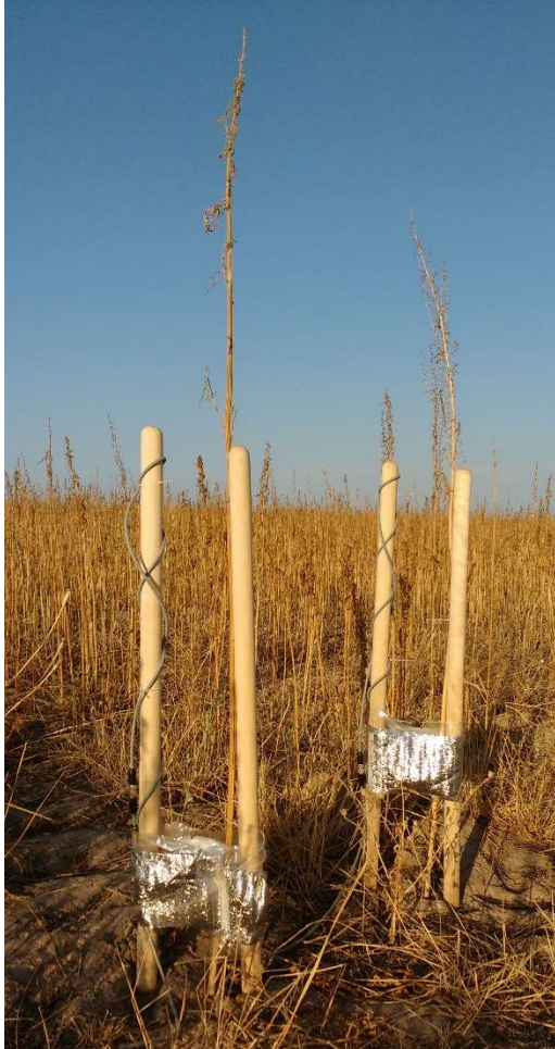
Abb. 1: Sap Flow Methode nach Granier.
