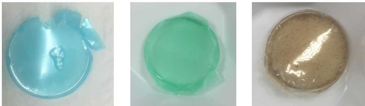
Abb. 3. Fotos der Polystyrol-Filme mit \text{Cu}^{2+} /BTC-Nanopartikeln (links), \text{Cu}^{2+} /4,4'-Bipyridin-Nanopartikeln (Mitte) und \text{Cu}^{2+} /2MI-Nanopartikeln (rechts).
