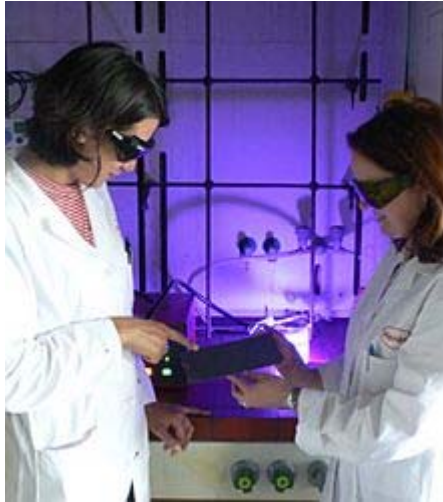
Emily Nixon (links) und Uta Sundermeier begutachten ein Edelstahlblech. Dessen Beschichtung härtete unter Licht aus.
